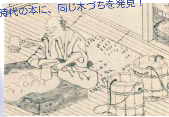
↑「美濃紙抄製図説」(明治13年発行)。石の台にのせた白皮を、同じ形をした木づちでたたいています。
