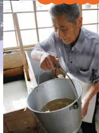
→ネリを投入するところ。ネリは、トロロアオイの根から抽出した粘液です。分散させたコウゾ繊維の浮遊状態を保ち、沈殿をおさえ、漉いて重ねた紙の張りつきをおさえ、はがしやすくなります。
